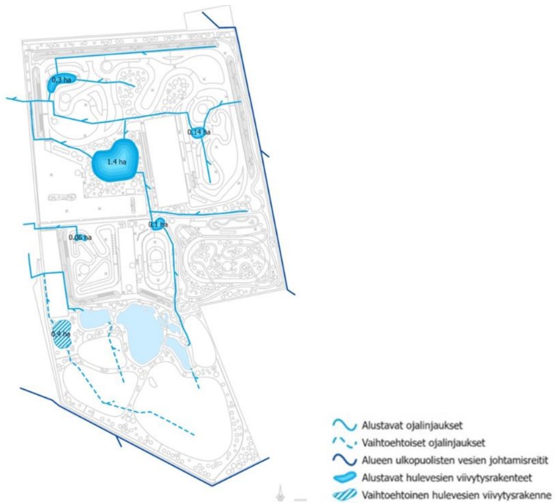
Kuva 23. Ote alustavasta hulevesitarkastelusta.
