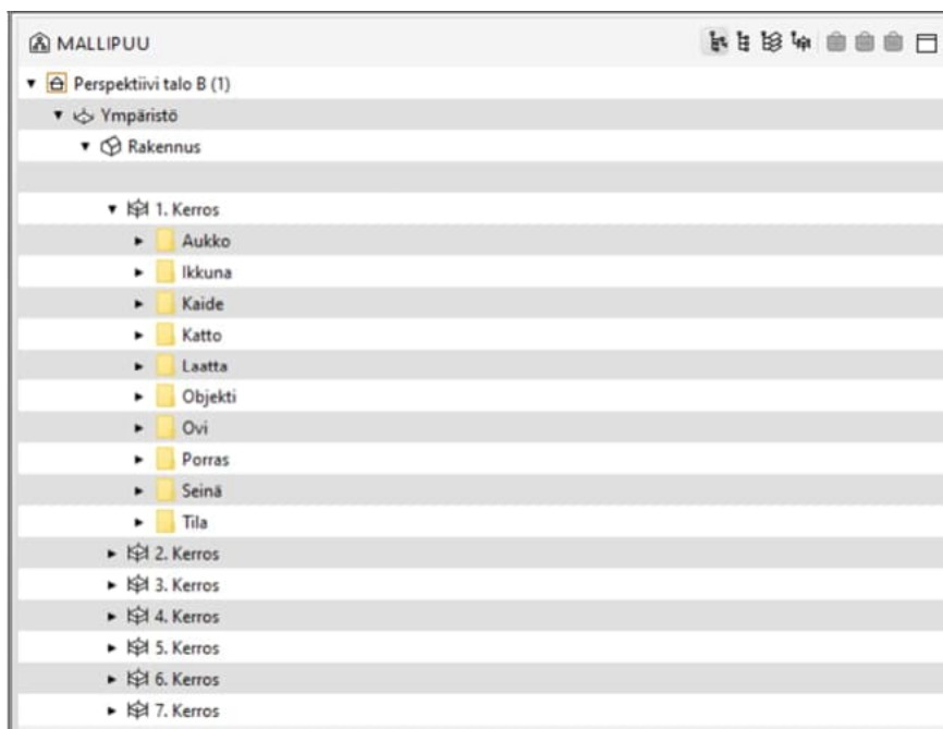
Kuva 7 Kerroksittain mallinnetun rakennuksen mallipuu
