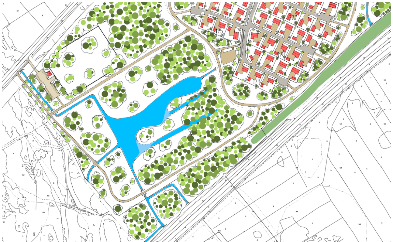
Ote havainnekuvasta. Nykyiselle Kärmeskydön alueelle on muodostettu hulevesien viivytykseen mahdollisuus toteuttaa altaita tai kosteikkoja. Alueen läpi kulkee Itäväylän eteläpuolisia hulevesiä. Kärmeskydön reunametsät on säästetty ja puustoa on lisätty entiselle pellolle kosteikon ympäristöön. Ruukintien varteen on osoitettu mahdollisuus toteuttaa isohko koirapuisto.
