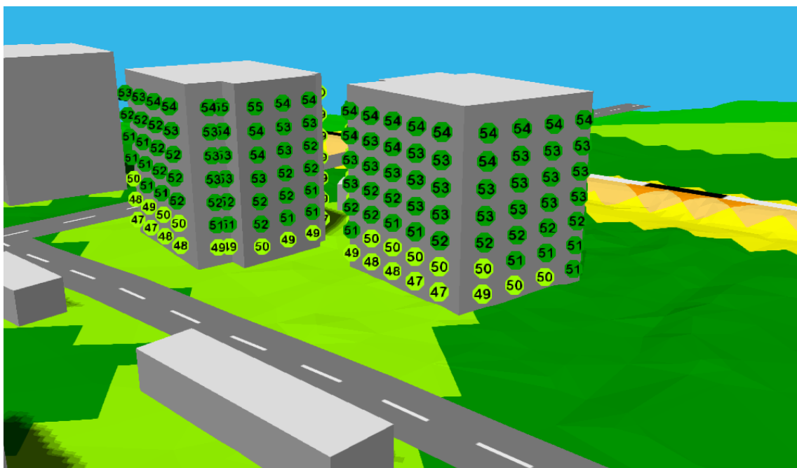
Kuva 3. Päiväajan keskiäänitaso julkisivuilla. Kuva Vaasantien suunnalta.
