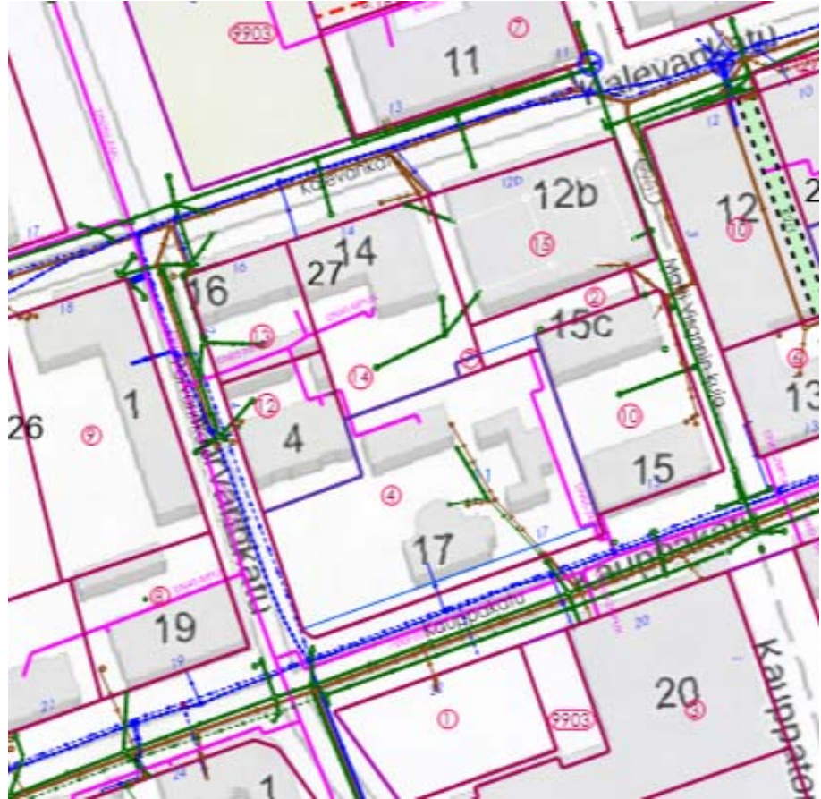
Kuva. Alueen kaukolämpö-, vesi- ja viemäriverkosto sekä hulevesiverkosto. Aniliinipunainen=kaukolämpö, siniset=vesi, ruskea=jätevesi, vihreä=hulevesi.
