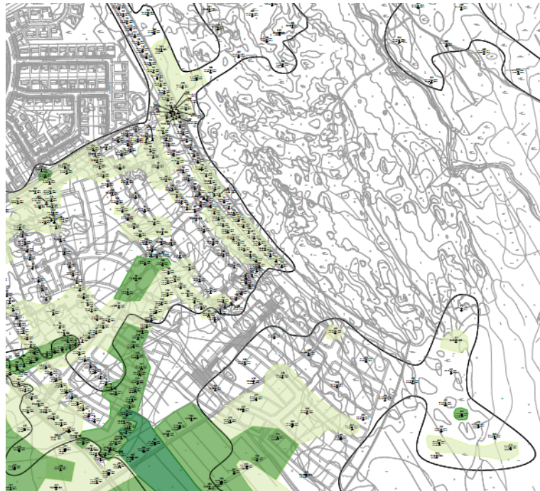
Ote pohjatutkimuskartasta 2012. Kuvassa vaalean vihreät alueet yli 0,5 m ja vihreät alueet yli 1 m turvetta. Mustalla rajauksella on osoitettu alueet, joissa joko heti turpeen alla tai pinnassa kova maa (kallio tai moreeni).
