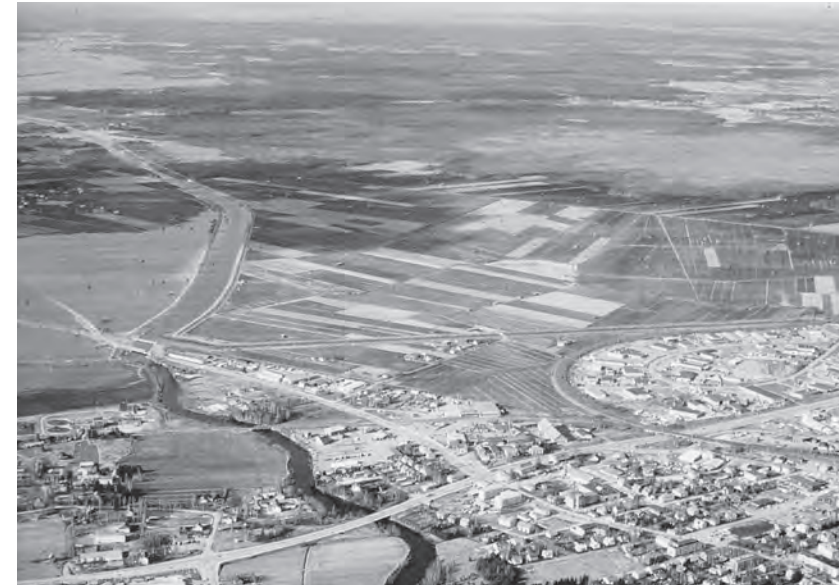
Vuoden 1984 suurtulvassa Pajuluoman pengerrysalue pysyi kuivana. Mittavan vesistörakentamisen seurauksena tulvat ovat poistuneet lähes kokonaan. (Valokuva: Unto Tapio kirjassa Kyrönjoen tulvasota.)
