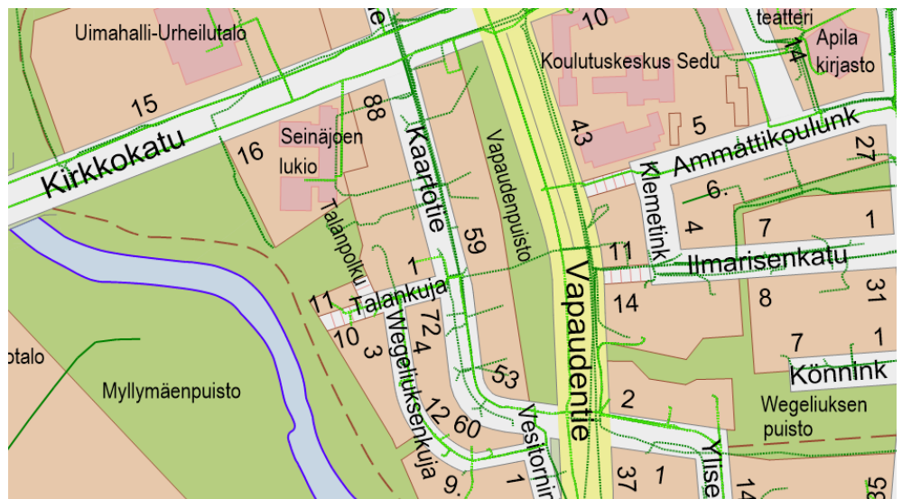
Kuva. Alueen sähköverkot. Vihreä = ulkovaloverkko, punainen = pienjänniteverkko, fuksia = 20 kV verkko.
