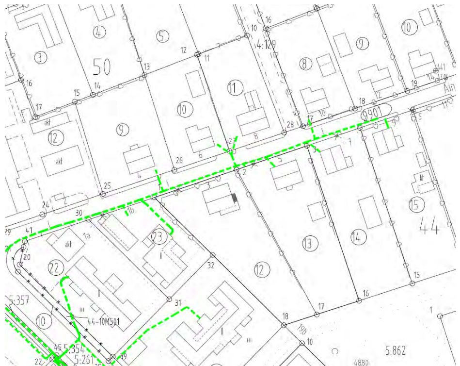
Anvia valokuitu- ja tietoliikennejohdot
