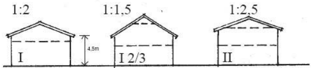
Kuva. Esimerkkejä rakennusten poikkileikkauksista ja niihin soveltuvista kattokaltevuuksista.
