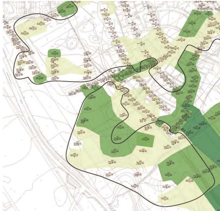
Kuva. Ote pohjatutkimuskartasta 2012. Kuvassa vaalean vihreät alueet yli 0,5 m, vihreät alueet yli 1 m ja tumman vihreät alueet yli 2 m turvetta. Mustalla rajauksella on osoitettu alueet, joissa joko heti turpeen alla tai pinnassa kova maa (kallio tai moreeni).
