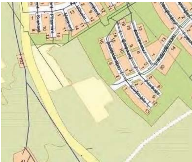
Kuva. Alueen vesi-, viemäri- ja hulevesiverkostot sininen = vesi, ruskea = viemäri, vihreä = hulevesi
