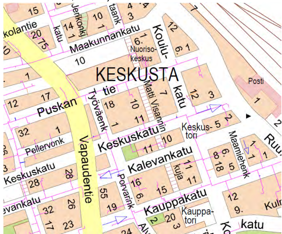
Kuva. Alueen kaukolämpöverkosto
