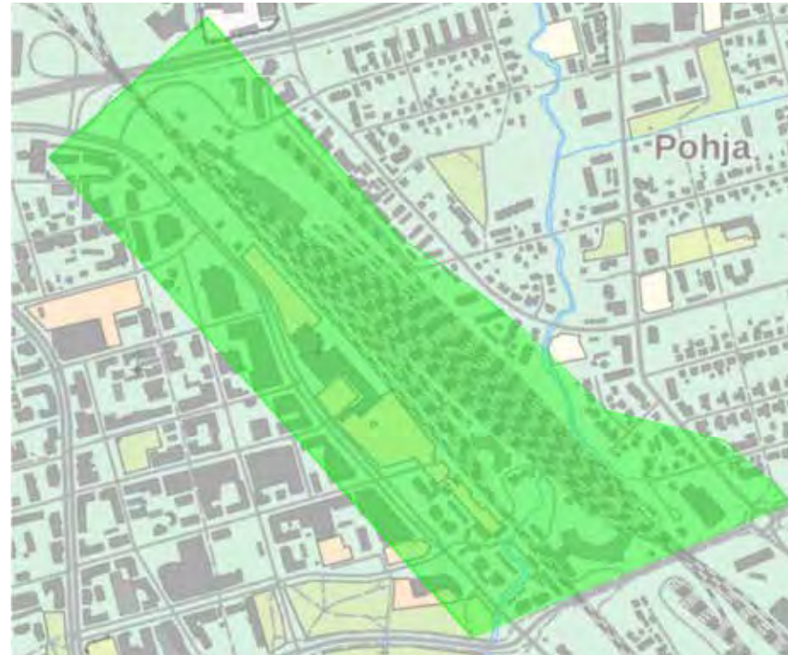
Kuva 11. Alue, jonka sisällä olevissa rakennuksissa tärinän häiritsevyys voi ylittää uusien rakennusten suositustason, riippumatta rakennetyypistä ja kerroskorkeudesta.
