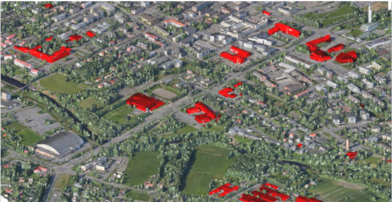
Viistoilmakuvien pohjalta voidaan muodostaa kolmiulotteinen malli ympäristöstä. Kuvassa on korostettu kaupungin omistamat rakennukset
