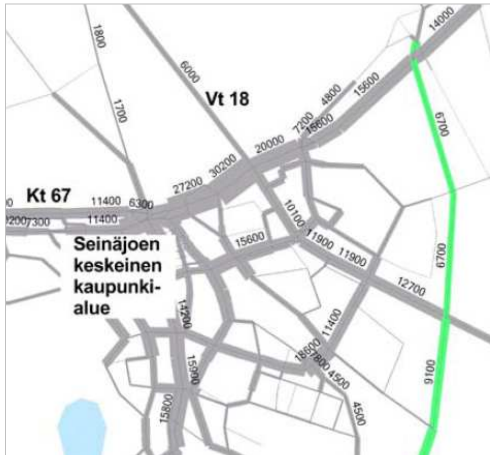
Kuva 1. Ote liikenne-ennusteesta 2030. Vihreällä on merkitty tuleva Seinäjoen itäinen ohikulkutie. (Tiehallinto, Valtatie 19 Seinäjoen itäinen ohikulkutie, yleissuunnitelma)
