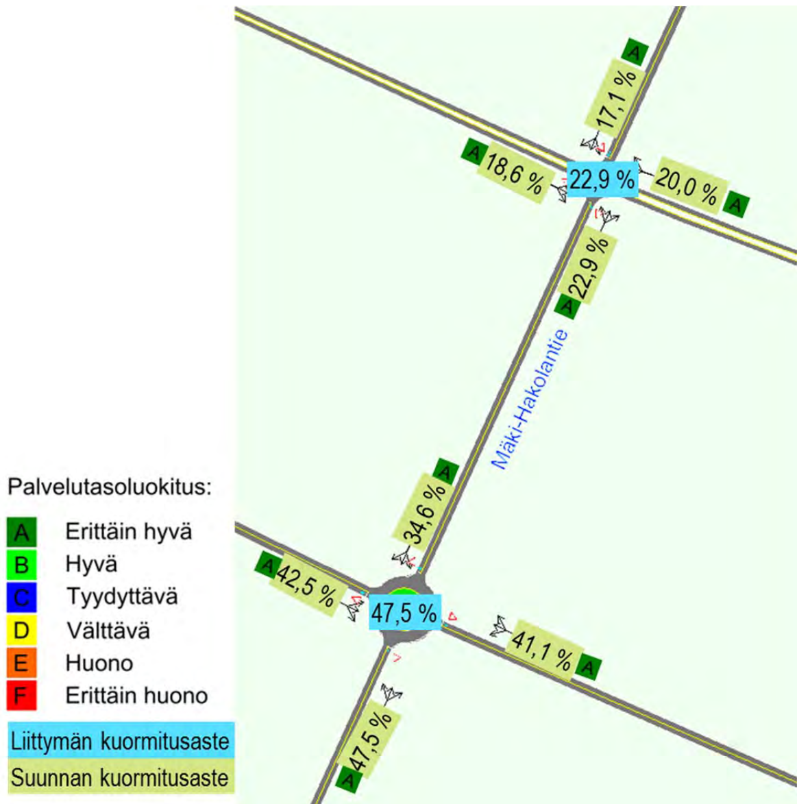
Kuva 8: Mäki-Hakolantien kiertoliittymien toimivuus nykytilanteessa iltahuipputunnin aikana
