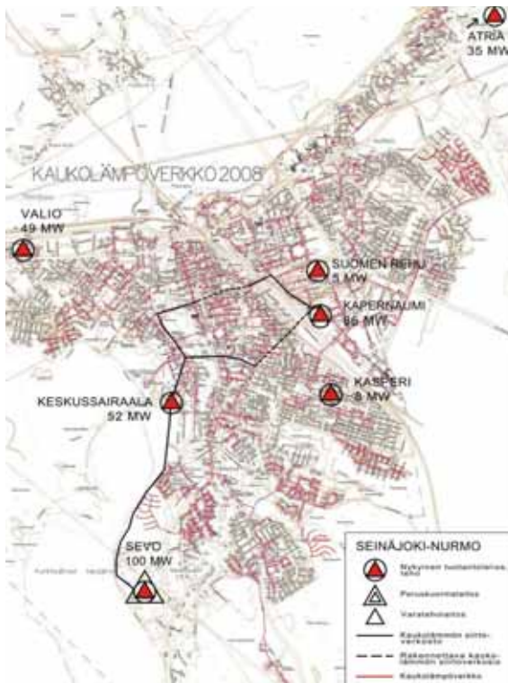
KUVA 7. NYKYISET TUOTANTOPAIKAT JA KAUKOLÄMPÖVERKKO (Lähde: Paikallisen energiatuotannon yleisselvitys, Pöyry 2008)
