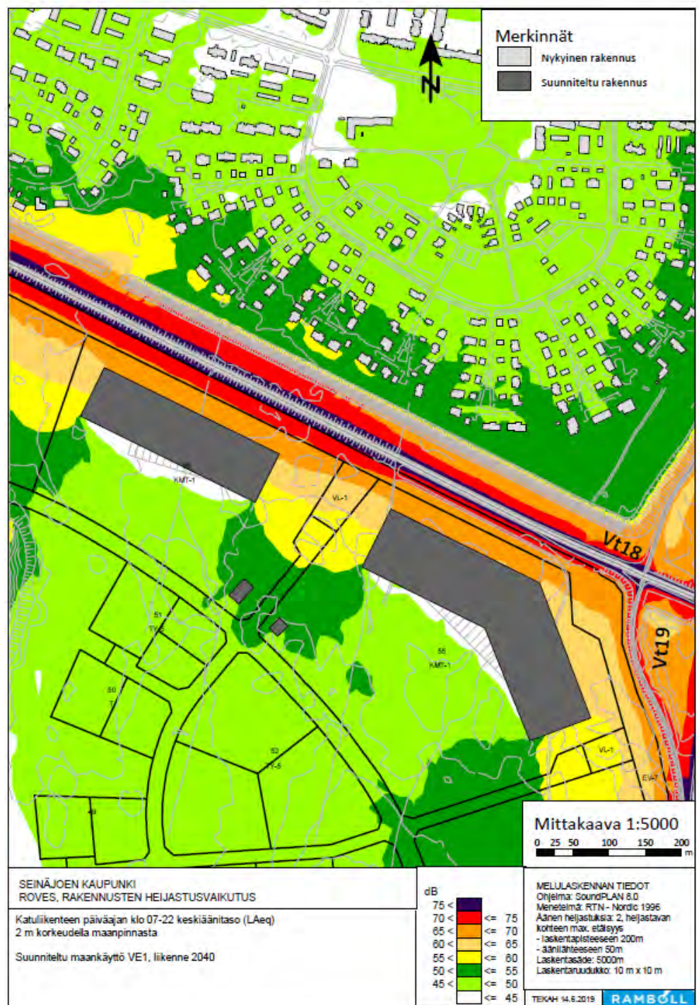
Kuva: Ennuste 2040, yöajan keskiäänitaso liikerakennusten vaikutus, nykyinen maavalli
