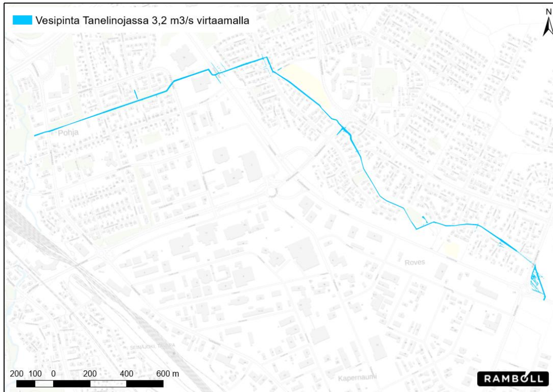
Kuva 3.4.2. Veden levittäytyminen Tanelinojassa vakiovirtaamalla 3,2 m³/s
