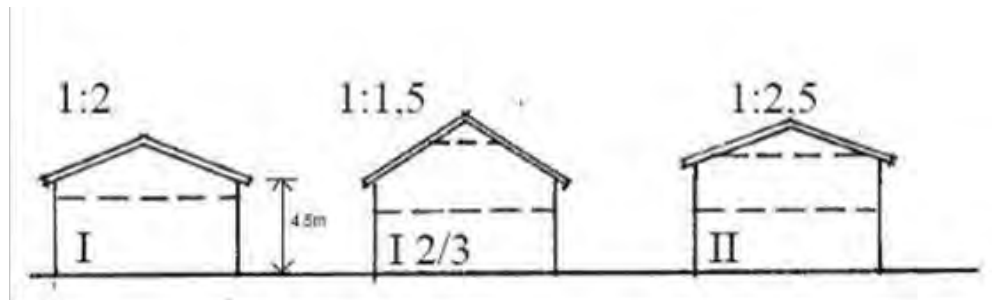
Kuvassa on esimerkkejä erillispientalorakennusten poikkileikkauksista ja niihin soveltuvista kattokaltevuuksista.
