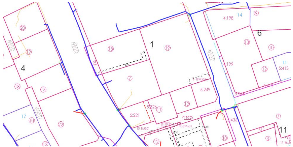
Kuva. Anvian verkostot. Sininen = kaapeli-tv, punainen = valokuituverkko, oranssi = kuparikaapeli, turkoosi = ilmakaapeli
